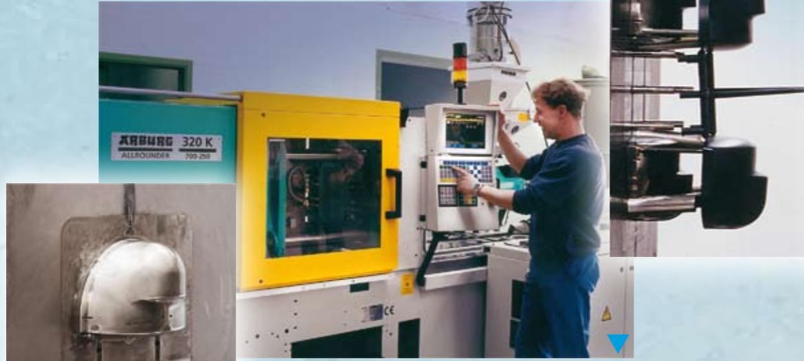
▼ L'injection en petite et grande série est exécutée sur des presses modernes allant de 25 à 320 T., pour un poids injectable maximum de  $\pm 1000$  g.
